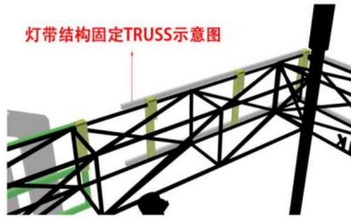
铁板挂钩挂在TRUSS上并安装螺栓防止滑落
